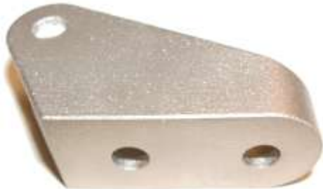
Radträger nach der Entfernung der Stützen
