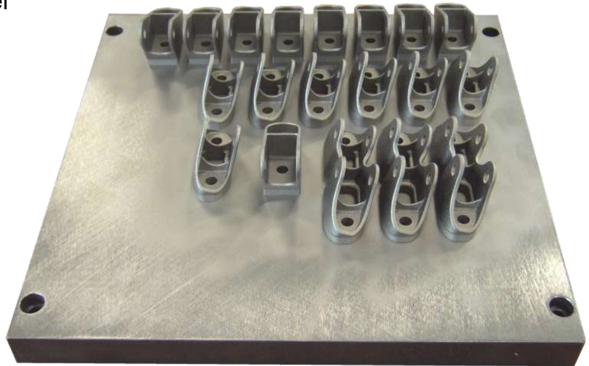
Radträger auf der Bauplattform
